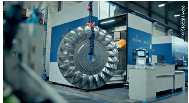
Mit der neuen Fünffach-Fräsbearbeitungsmaschine können ab Sommer dieses Jahres Laufräder mit bis zu 3,1 m Durchmesser gefertigt werden.
