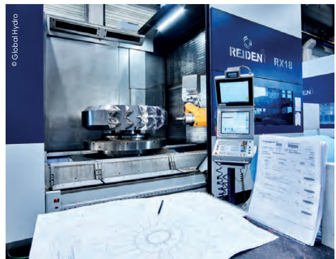
Moderne Zerspanungstechnik ist unerlässlich: Das neue 5-Achs-Fräszentrum wird komplett auf die Bedürfnisse des Turbinenbauers adaptiert.
