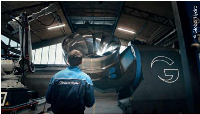
Geschweißt wird bei Global Hydro per Roboter: Das spart nicht nur Zeit, sondern stellt auch ein hohes Qualitätsniveau sicher.
